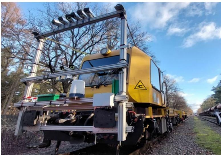
*Sensorkonfiguration am Datenerhebungsfahrzeug (Quelle: DB Netz AG)*
